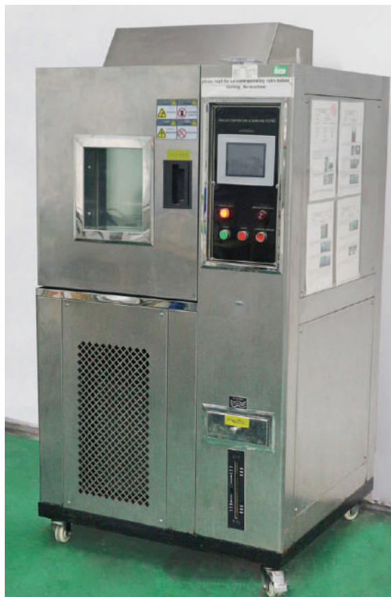
Cámara climática, con rango de ajuste de temperatura de -90 a +150^{\circ}C , rango de ajuste de humedad relativa de 1 a 100 %
