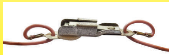
Limitador de temperatura de manta térmica de rotura lenta Calor, calibrado a 80 °C (circa 1960). Nótese la funda impermeable de PVC soldada en los cables y el bucle hecho por los conductores eléctricos que pasan por un agujero en cada terminal, esto es para eliminar tensiones de tracción en el cable (Colección Ultimheat)
