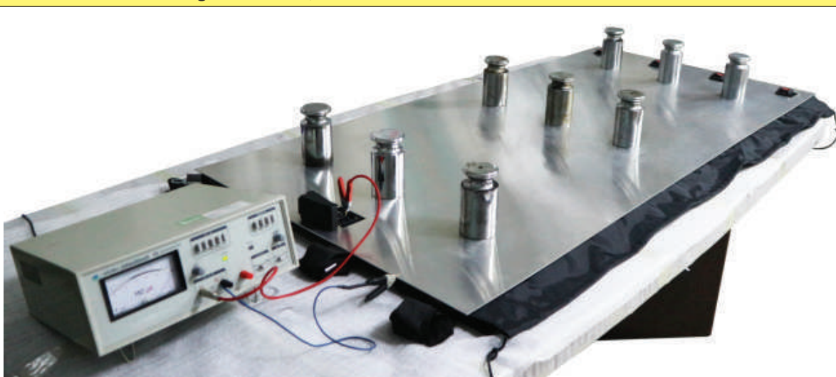
Dispositivo para medir la resistencia de aislamiento. Los valores medidos son siempre mayores a 0,1 Gohmios
