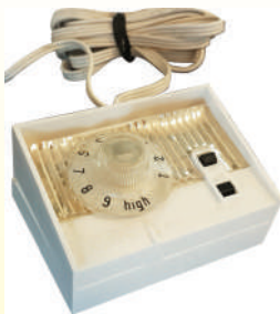
Circa 1970. Ajuste de potencia de GEC (General Electric, Inglaterra) en una manta térmica inglesa. La resistencia anticipada es claramente visible sobre la bimetálica y el interruptor lento (Colección Ultimheat).
